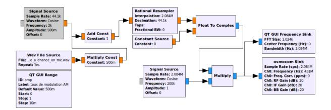
On peut émettre un signal sinusoïdal ou le contenu d'un fichier wav mono. On part d'un signal <u>réel</u> issue d'un microphone (via audio source), d'un fichier wav ou d'un signal sinusoïdal qu'on transforme en signal complexe (avec partie imaginaire à 0). Le block "Rational Resampler" permet d'adapter les fréquences d'échantillonnage (rééchantillonneur fractionnaire) :
