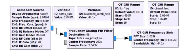
La variable samp\_rate représente la fréquence d'échantillonnage RF (ici 2.048MHz). La variable baseband\_samp\_rate est la fréquence d'échantillonnage souhaitée en bande de base (dépend de la bande passante du canal à recevoir).
