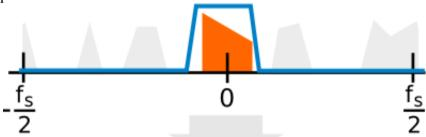
Et enfin réduire la fréquence d'échantillonnage pour diminuer le flux de données et ne pas faire des calculs inutiles (décimation) :
