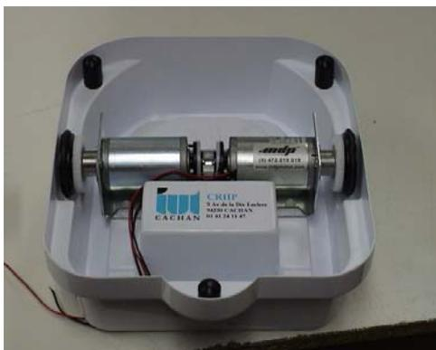
La partie puissance doit être alimentée par une batterie au plomb de 12 Volts d'une capacité 1,2 A.H.
